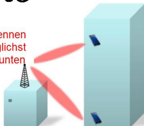
Abbildung 3: Antennen von 5G möglichst nahe dem Erdboden und fokussierte Ausbreitung
